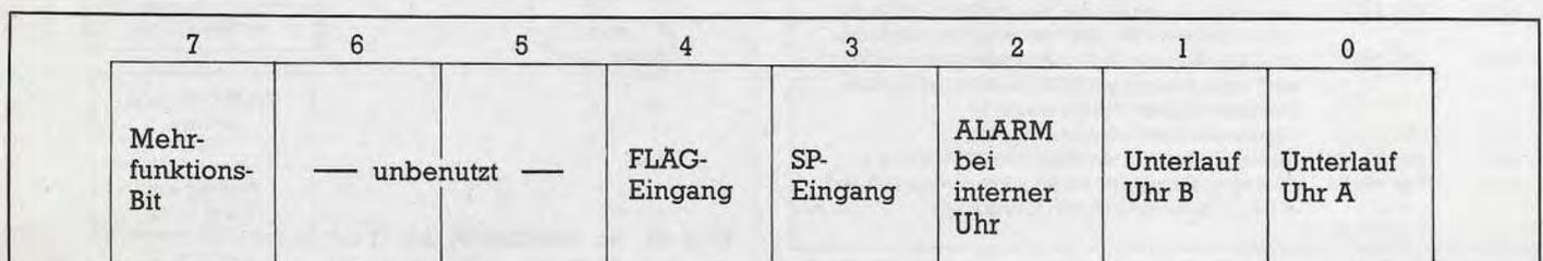
Bild 40. Genereller Aufbau der Unterbrechungs-Kontroll-Register (13) der beiden CIA-Bausteine
